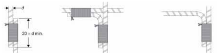
ČSN EN 62305-3 Obrázek E.5c – Svázané spoje (vhodné pro bleskové proudy a účely EMC)
