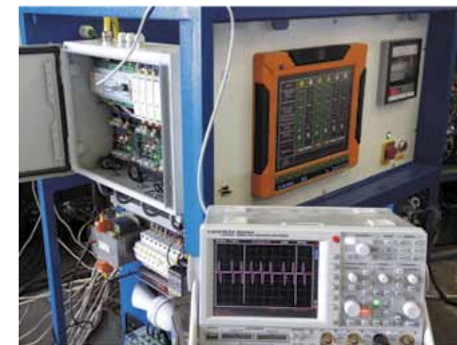
Obr. 16. Experimentální měření na žhací jednotce zdroje a žádané hodnotě proudu 50 A
