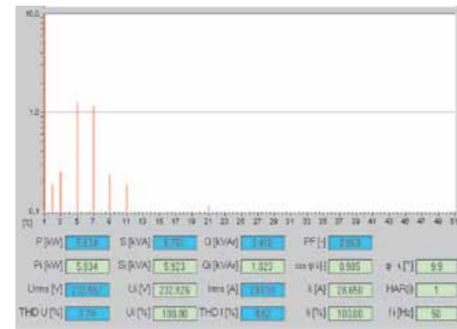
Obr. 15. Harmonická analýza proudu a napětí při celovlnném řízení žhacího zdroje a žádané hodnotě proudu 50 A
