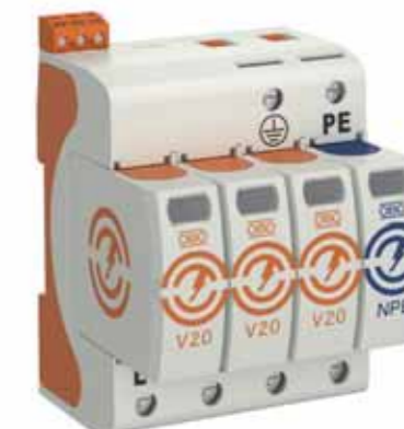
Obrázek 4: Sestava SPD typu 2 pro síť TN-S s mechanickou aretací zasunutého horního dílu a přepínacím kontaktem dálkové signalizace
