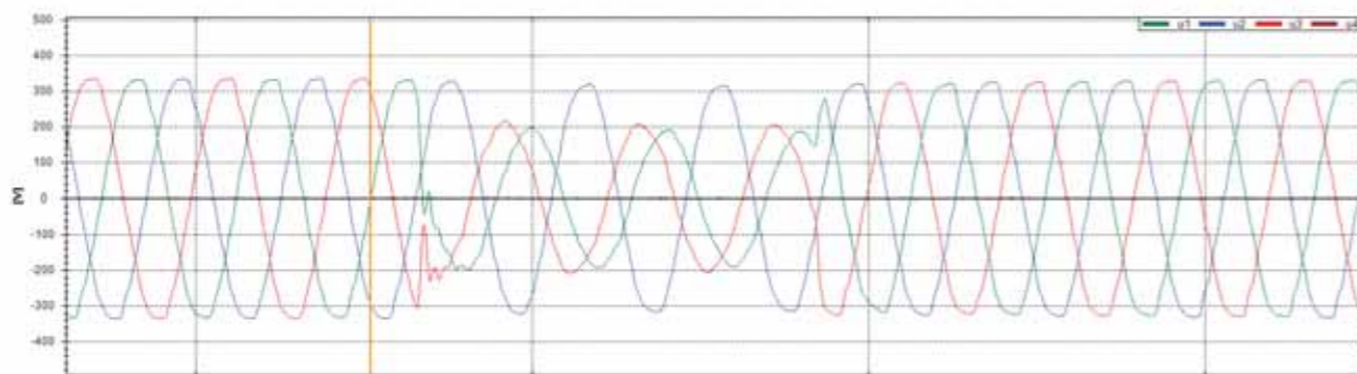
Osciloskopický průběh poruchy napětí. Modul GO.
