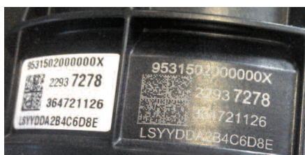
Příklad náhrady drahé etikety pomocí nekontaktního značení zeleným laserem.
