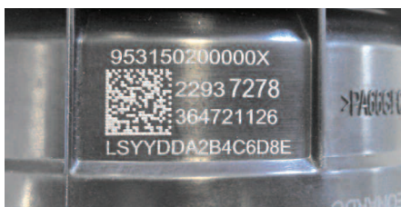
Velmi kontrastní značení pomocí zeleného laseru Solaris na černém pozadí.
