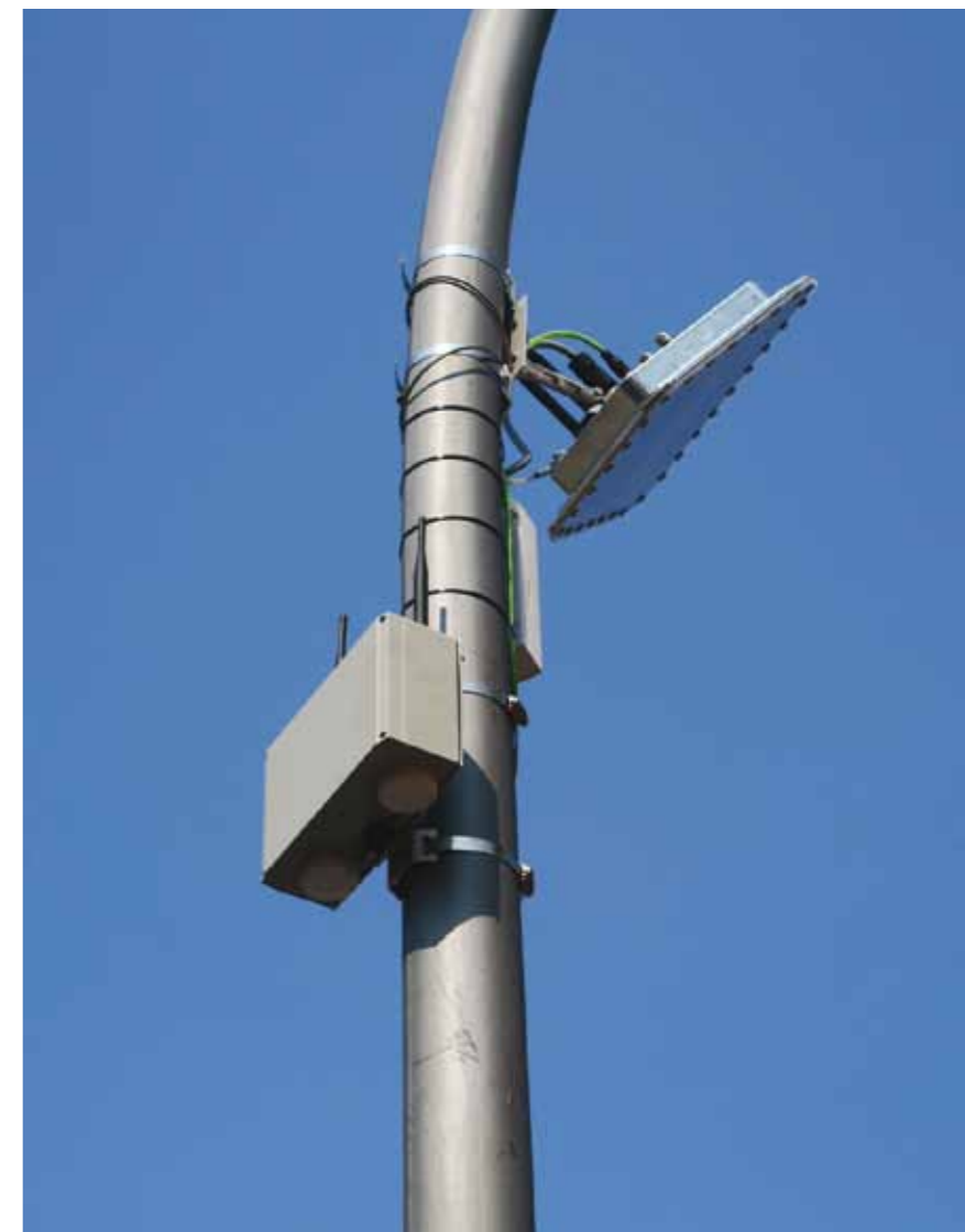
Radarové senzory dokážou efektivně najít nelegálně zaparkovaná auta – například automobily stojící na cyklostezkách nebo na parkovacích místech, které jsou vyhrazené pro zdravotně postižené.
