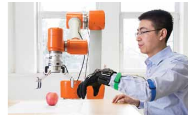
Komunikace skrze jazyk je s ohledem na hluk v průmyslových továrnách nemyslitelná. Vědci ze společnosti Siemens proto pracují na vývoji datové rukavice, která přesně snímá pohyby lidské ruky a je schopná je reprodukovat
