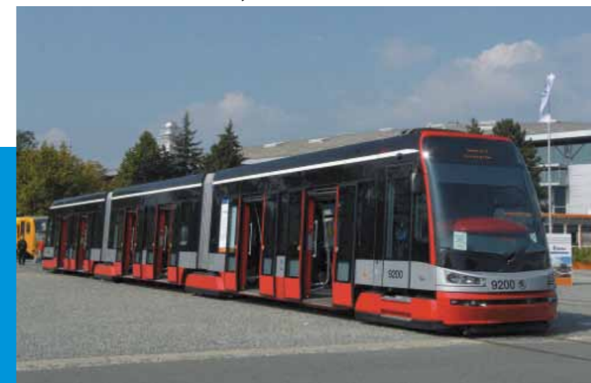
Aplikace - nejmodernější typ nízkopodlažní tříčlánkové tramvaje s asynchronními motory ŠKODA ForCity
