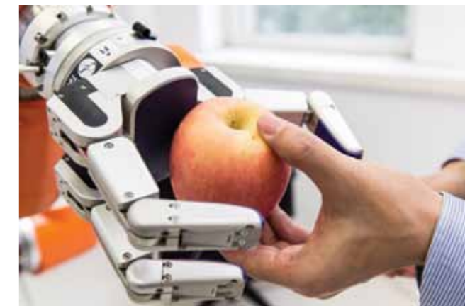
Odborníci vyvíjí i nový řídicí systém, který by měl korigovat nejen pohyby robota, ale i sílu stisku jeho paží.
